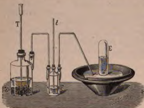
Fig. 76. — Préparation du gaz sulfhydrique. Zn, zinc et eau acidulée. — F, lavour. — E, gaz dégagé.
